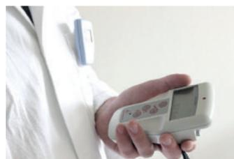
Appareil de mesure en radioprotection (RADIAGEM)
